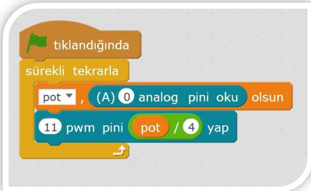
mBlock Kodu 13: Potansiyometre ile Led Parlaklıęını Deęiřtirme Uygulaması
