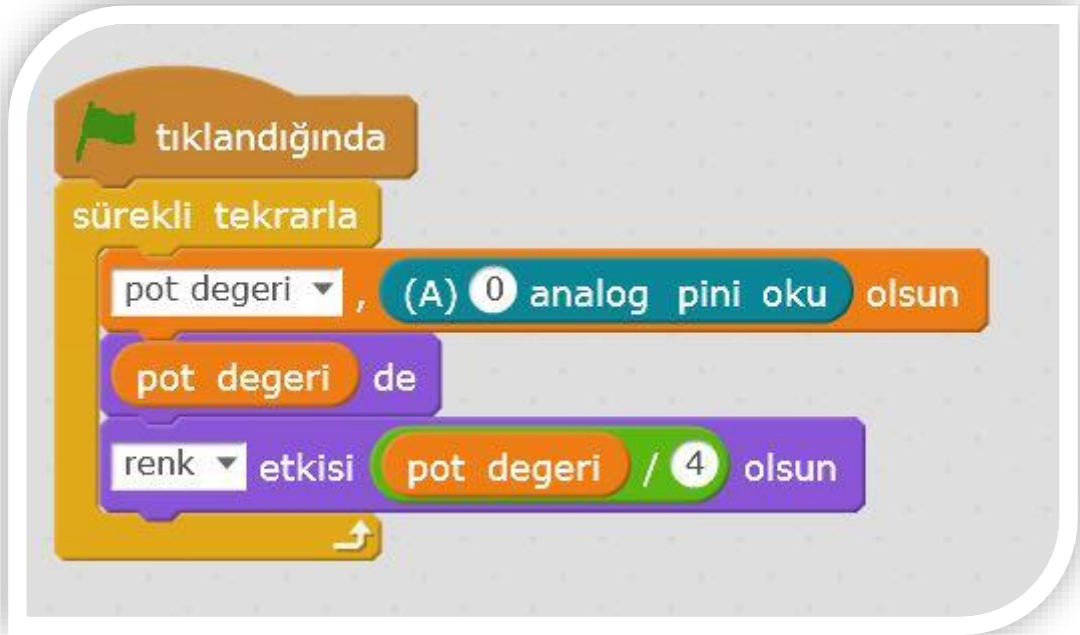
mBlock Kodu 12: Potansiyometre ile Pandanın Renk Etkisini Arttırma Uygulaması
