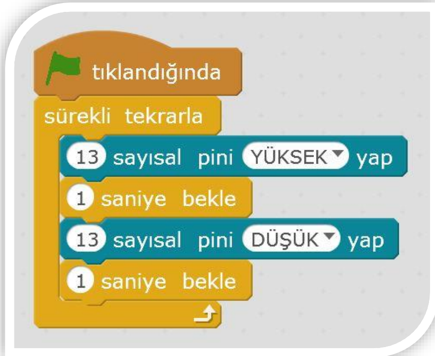
mBlock Kodu 1: Blink-Yan Sön Uygulaması
