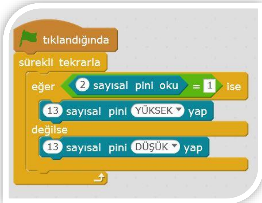
mBlock Kodu 4: Buton ile Led Yakma Uygulaması
